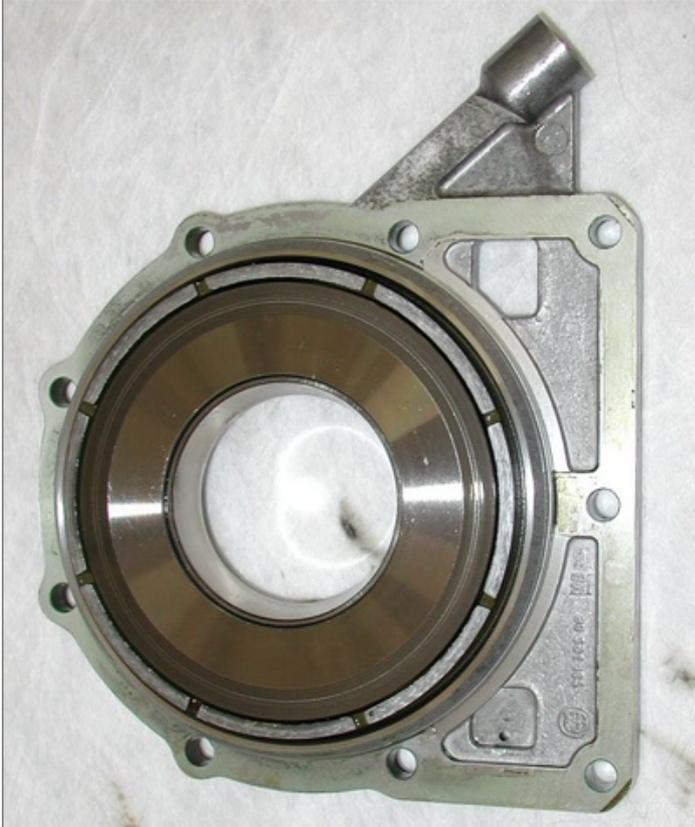
Por el tubo que se proyecta oblicuamente hacia fuera le llega la presi n hidr ulica para operar. Cuando el peloto expira, por este tubo llega de golpe mucha m s presi n de la debida, la placa revienta, el zumo PAS entra arrasando hacia el diferencial viscoso, empuja el lubricante y el c ctel subsiguiente sale a borbotones por el manguito de respiraci n del tr nsfer. Sit Tibi Terra Levis.
