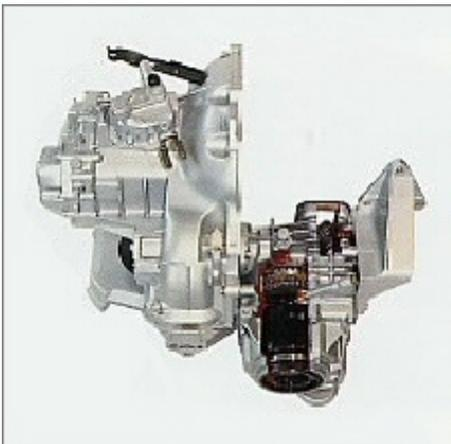
La gran particularidad especial del Calibra Turbo es que su diferencial viscoso central o tr nsfer tiene su propio embrague, que lo desconecta al pisarse el freno a velocidades por encima de unos 25 km/h. Este embrague es operado por presi n hidr ulica desviada del circuito PAS de la direcci n asistida, actuando sobre una placa de presi n. Esta 'rareza' mec nica suele volver loco a todo mec nico que no se sepa bien la copla, lo que a menudo desemboca en ñapas atroces.
